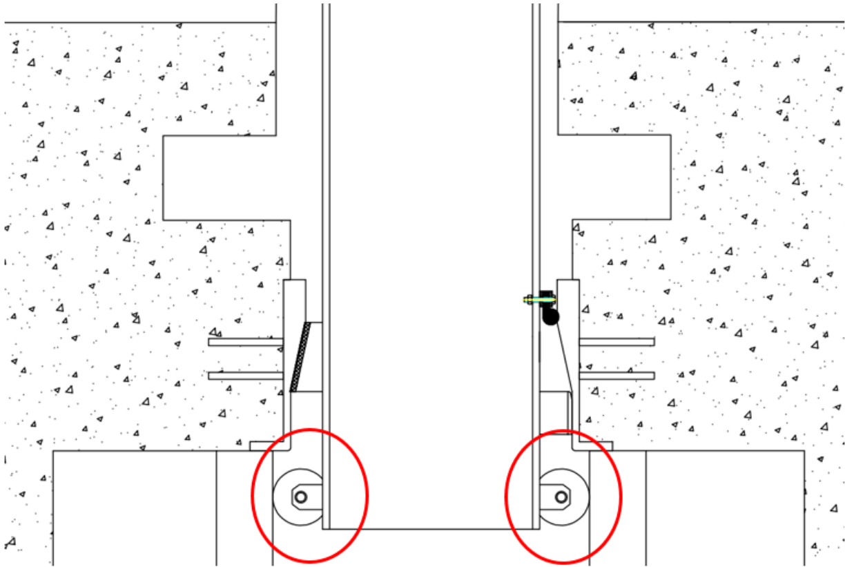
Figure 24: Représentation du système de guidage latéral dans l'encoche de la porte (position porte sortie)
